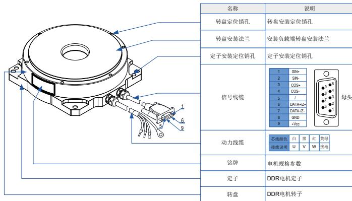
ISMT1-085S03AB-S132X、ISMT1-160F12AB-A332X、ISMT1-160F12AB-S232X、ISMT1-208S75AB-A532X、ISMT1-208S11BB-A532X各部件名称（示意图）
