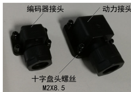
图 4-47 编码器 / 动力接头
