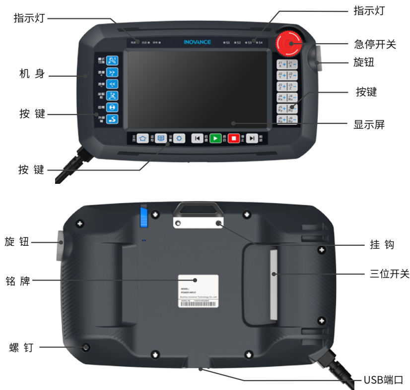
图 6-1 IRTP80 示教器外观示意图
