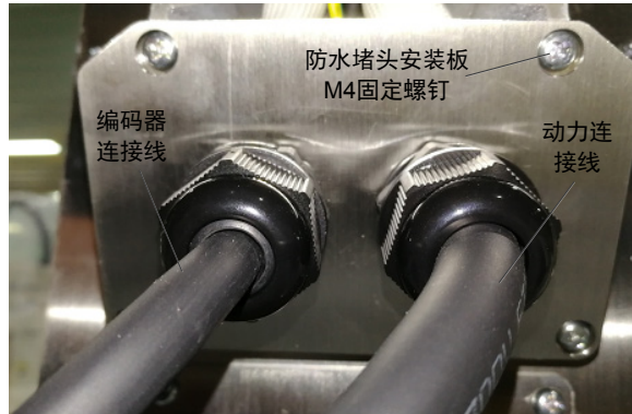
图 4-58 防水堵头安装板 (IRS100-20 系列)
