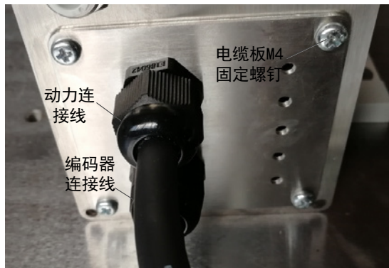
图 4-55 电缆板固定螺钉（IRS100 系列）
