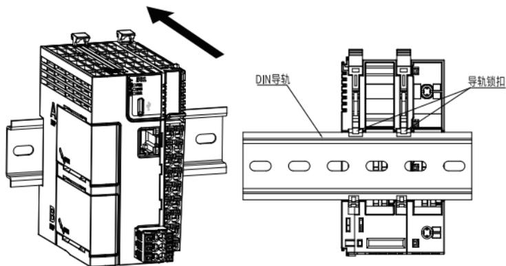
2. 确认主机的DIN导轨锁扣为锁定状态，导轨锁扣锁定与解锁状态如下图所示。
