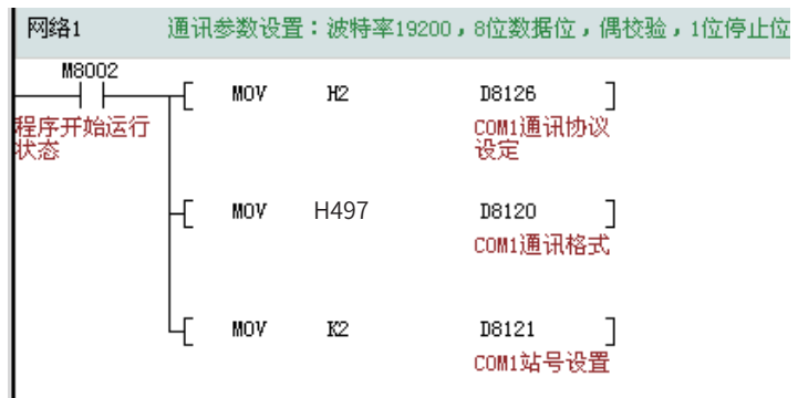
从机 PLC COM1 口参数设置
