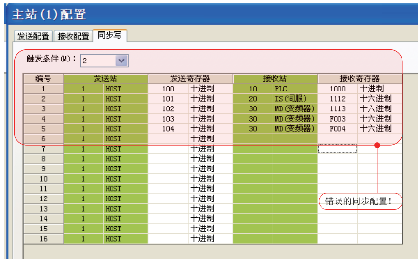
图 错误的同步配置
