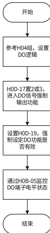
图 4-11 DO 信号强制输出设定步骤示意图
