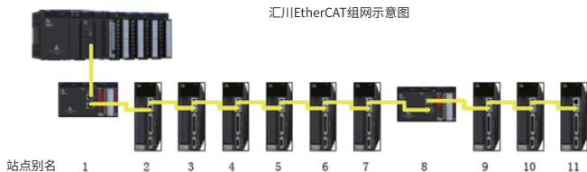
图 2-10 汇川 EtherCAT 组网示意图
