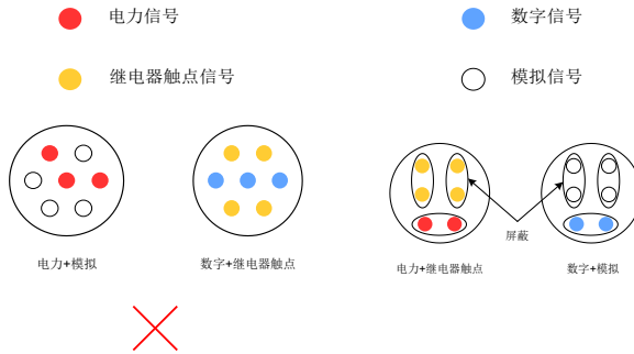
图 4-3 多芯电缆布线示意图
