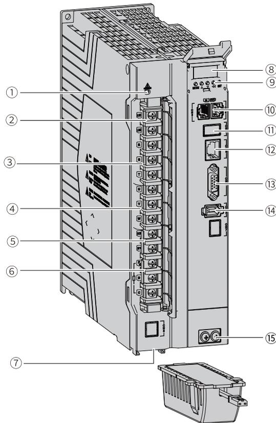
图2-6 伺服驱动器部件说明示意图（SV660NT017I、SV660NT021I、SV660NT026I）
