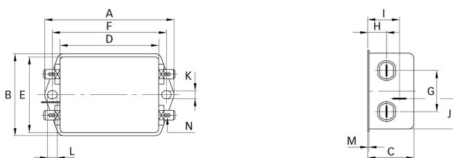
图4-3 FN2090系列滤波器尺寸图(单位: mm)
