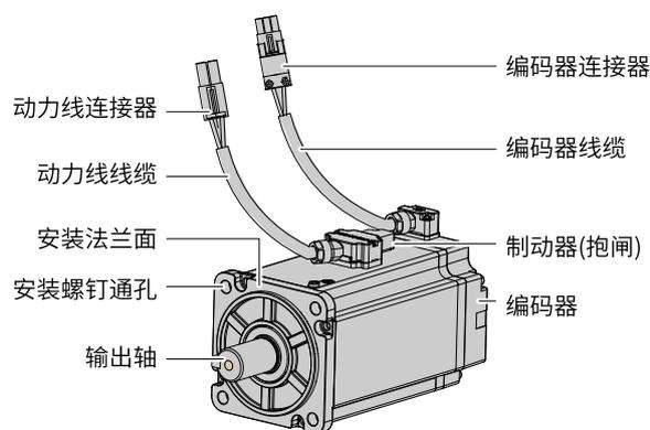
图3-5 甩线型伺服电机部件说明示意图
