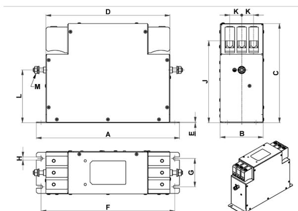
图4-4 FN 3287系列滤波器尺寸图(单位: mm)
