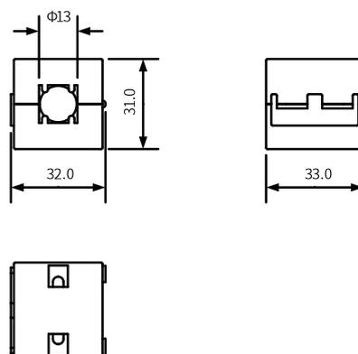
图4-6 磁扣尺寸图
