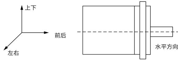
图3-8 伺服电机承受的振动
