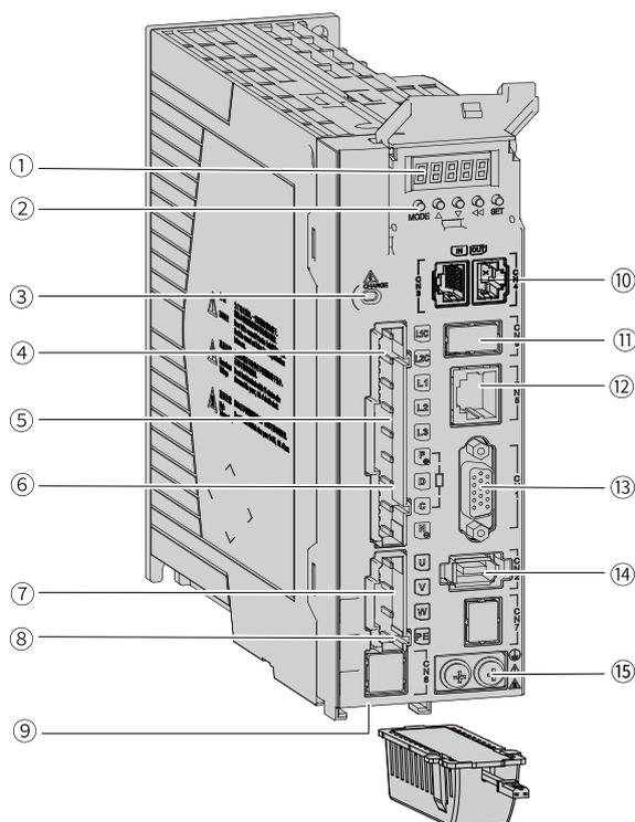
图2-4 伺服驱动器部件说明示意图（SIZE C:SV660NS7R6I/SZIE D:SV660NS012I）
