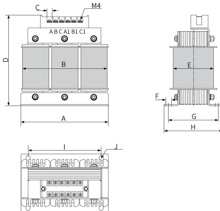
图4-1 10-15A 交流输入电抗器尺寸图
