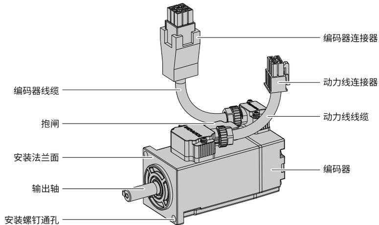
图3-3 甩线型伺服电机部件说明示意图
