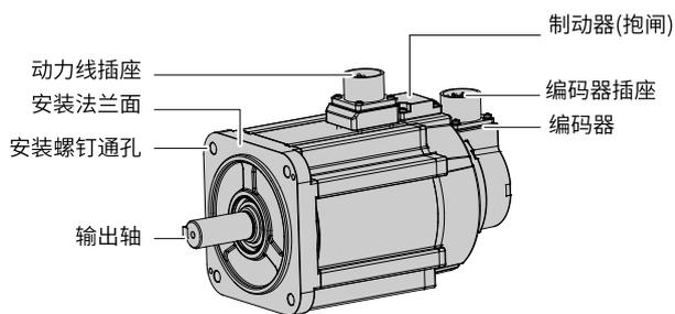
图3-6 伺服电机（100/130/180机座）部件说明示意图
