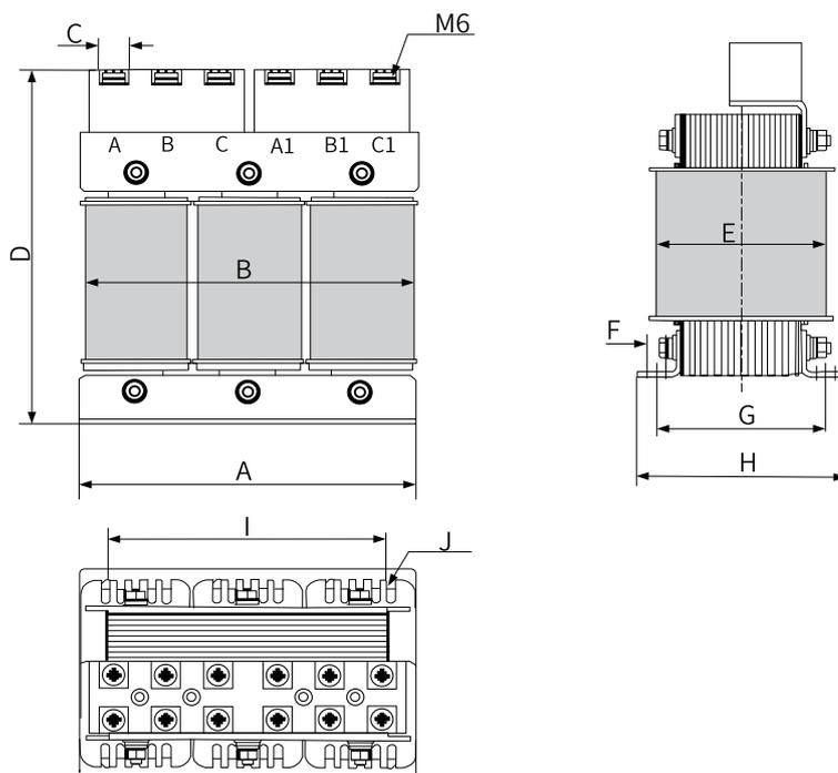
图4-2 40A (1.45mH) 交流输入电抗器尺寸图
