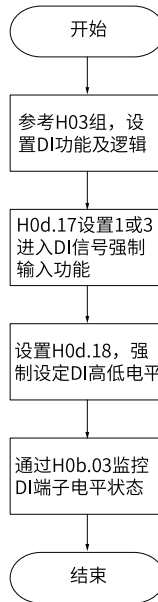
图1-7 DI信号强制输入设定步骤示意图
