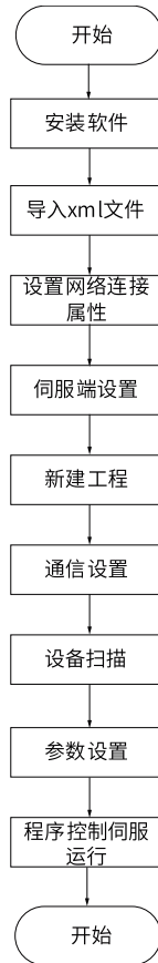
图6-2 SV670N配合欧姆龙控制器配置流程图
